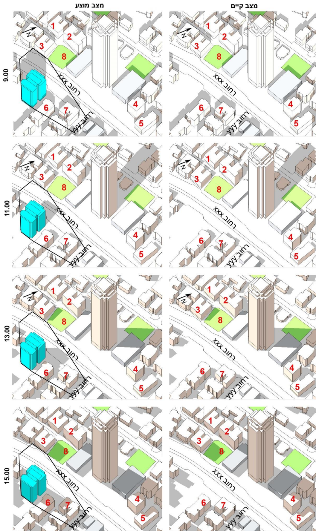
חותם הצל המצרפי של הבניין המוצע ב-21 במרץ 9.00-15.00 תרשים 3: בדיקת הצללה ב-21 במרץ בין השעות 9.00-15.00. מצב קיים ומצב מוצע.
